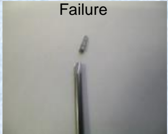
切削試験中に破損 した歯科用切削工具
